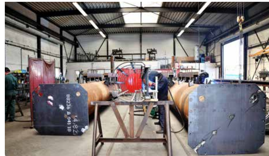
Realisatie van meetpalen in de stalhal van De Boer & De Groot.
